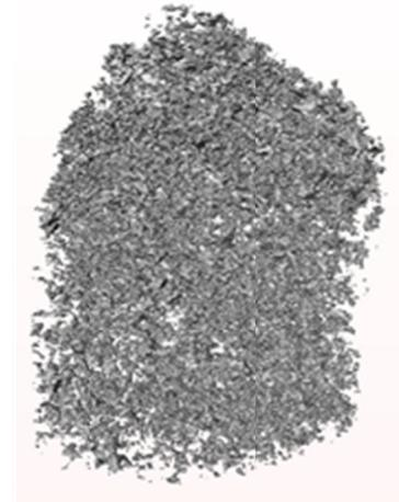
(d) 3D volume rendering of pores within the aggregate
